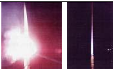
Tungsten staaf verdampt binnen enkele seconden
